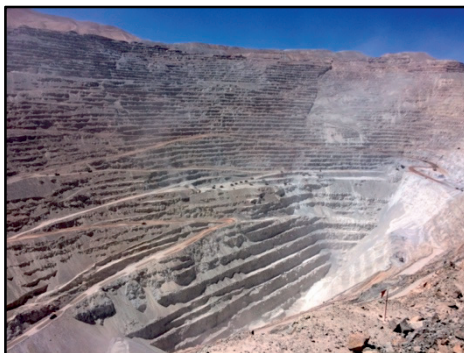
Abb. 10: Die Chuquibambilla Mine in der Region Antofagasta gilt als der weltweit größte Kupfertagebau und wird von dem Staatskonzern Corporación Nacional del Cobre de Chile (CODELCO) betrieben. An seiner tiefsten Stelle misst der Tagebau etwa 1.100 Meter (Foto: BAYER, Dezember 2018)
