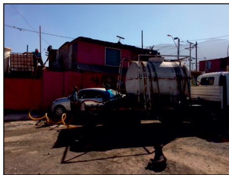
Abb. 43: Wasserlieferung eines Camión Aljibe in einem Campamento : Über den Schlauch wird das Wasser in einen Bin mit 1.000 Liter Fassvermögen befördert, der sich auf dem Dach eines Wohnhauses befindet (Foto: BAYER, März 2018)
